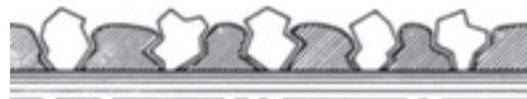
Industriediamanten in einem Diamantschleifer: Die besonders langlebige galvanische Bindung umschließt einen Großteil der Kristalle.
